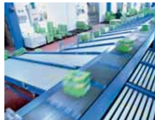
Sorter de banda transversal, bandas de unión y de entrada
