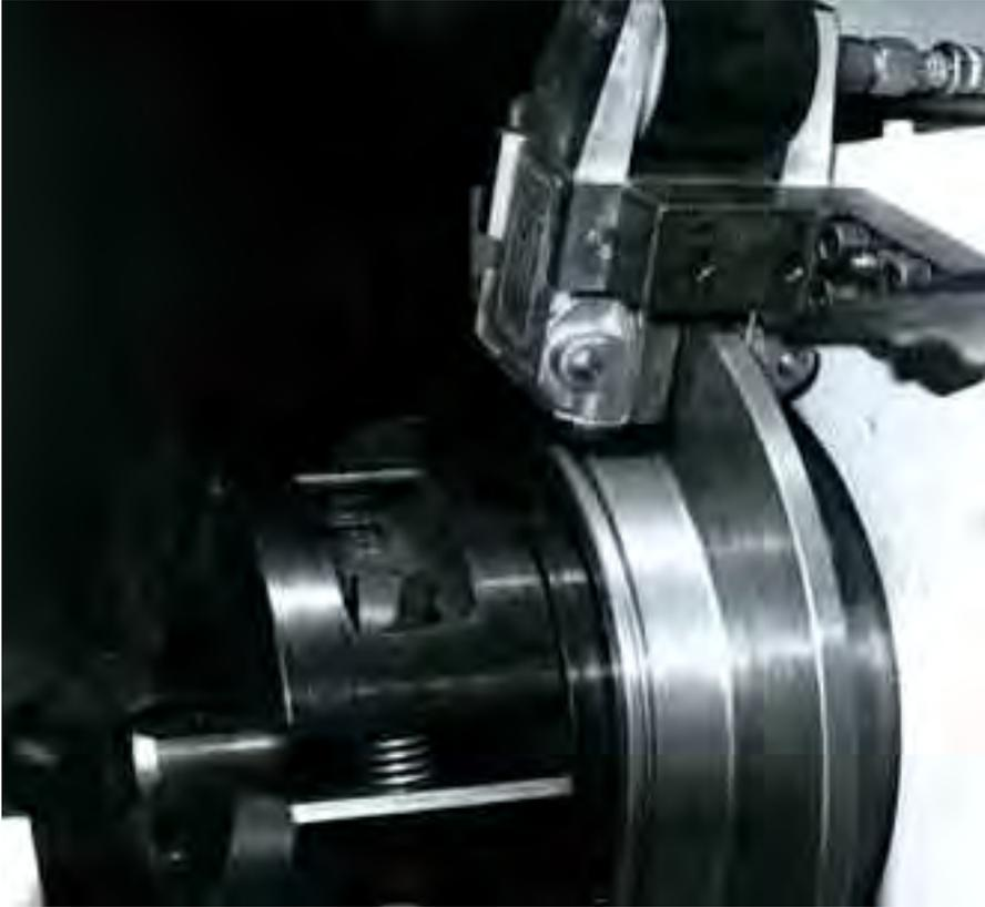
Freno neumático DH 15 P en el accionamiento de una impresora. En cada impresora esta instalado un freno entre el accionamiento y el acoplamiento como freno de emergencia en caso de ruptura del papel.
