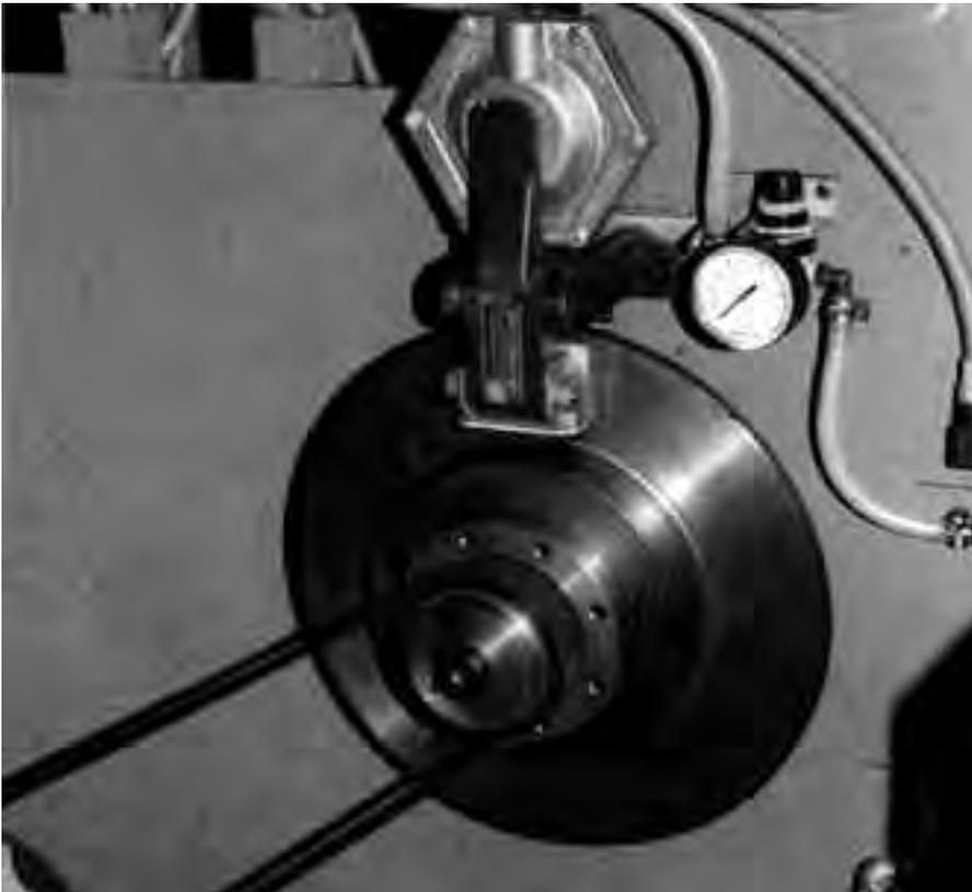
Freno neumático DV 20 P en el accionamiento de una tensadora de alambre. En el proceso de tiro del alambre la fuerza de tiro ha de ser constante. En caso de parada de la máquina el freno mantiene la fuerza de tiro constante para que cuando se reanude el proceso no se produzcan desperfectos en las matrices o se rompa el alambre. En este caso el freno actúa como freno de emergencia parando la máquina.
